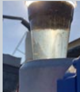
Mit VernEx P gereinigtes Abwasser. Schlamm flotierte
