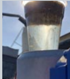
Acque reflue depurate con VernEx P. Fango flottante
