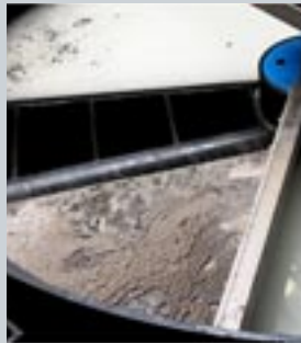
Separazione dei fanghi flocculati formati mediante VernEx P e introduzione di aria
